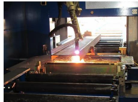
Sistema de rodillos utilizado para mover en material en fabricación
