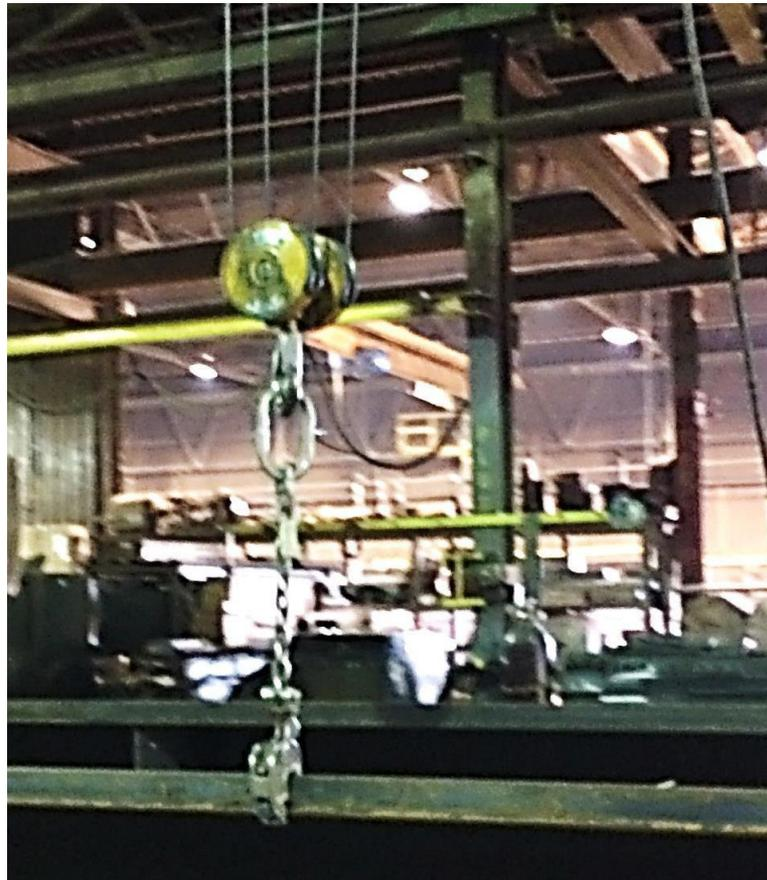
Grúa elevada, cadena, gancho y herrajes utilizados para mover las vigas durante la fabricación.
