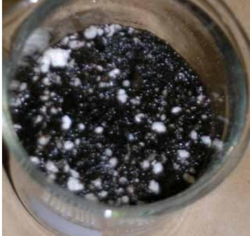
**Figura 5.** Cuando se realice el método de extracto de saturación del sustrato, el sustrato debe estar saturado pero sin agua sobre la superficie del sustrato.
