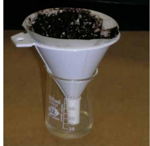
**Figura 6.** Para los métodos de extracto de saturación del sustrato y dilución 1:2, vierta las muestras en embudos limpios cubiertos con papel filtro o filtro de café para coleccionar el extracto.
