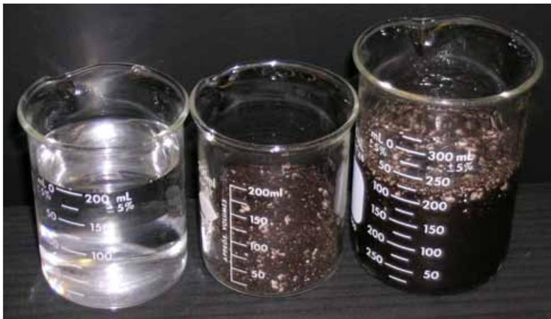
**Figura 7.** En el método de dilución 1:2, combine una parte (medida según el volumen) de sustrato con 2 partes (según volumen) de agua destilada.
